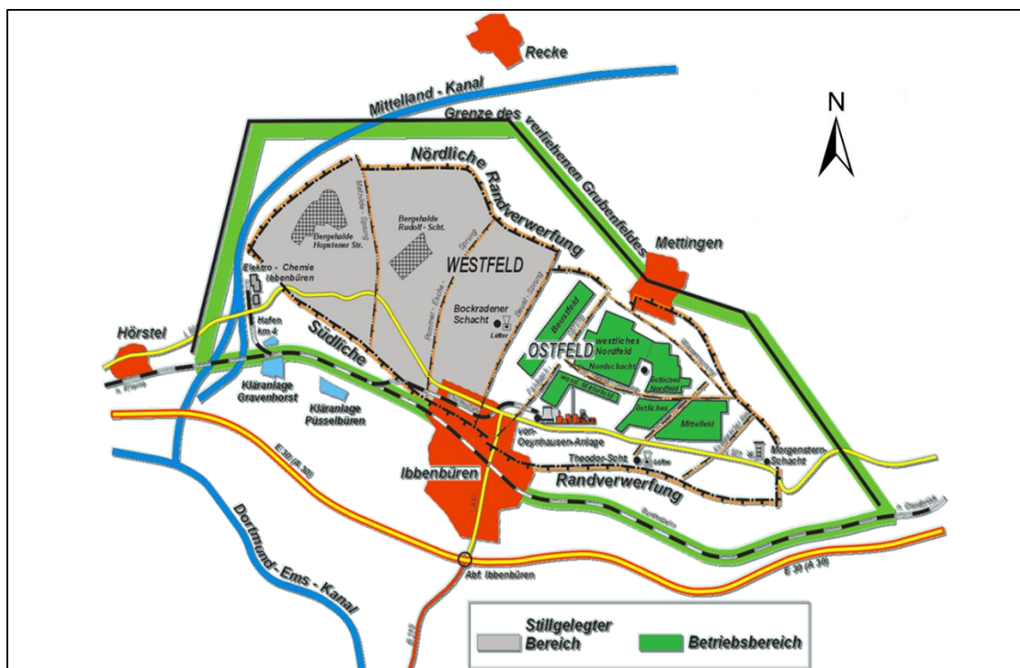
Abbildung 19: Berechtsame, Großtektonik und Baufelder des Bergwerks Ibbenbüren (KUNZ et al. 2014)
