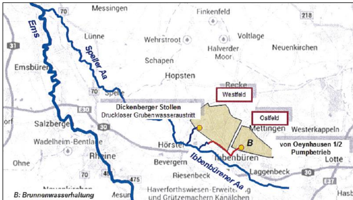
Abbildung 16: Grubenwasserhaltung Ostfeld/Westfeld des Bergwerks Ibbenbüren (RAG AG 2014)
